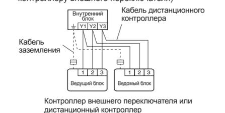
(2) Установка двухпозиционного переключателя контроллера внешнего переключателя
